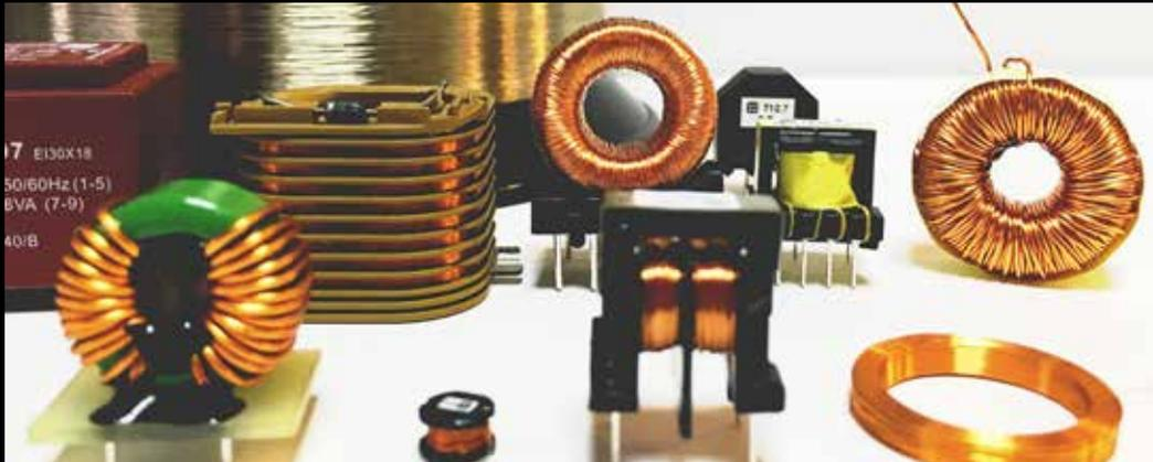
Le fil émaillé est utilisé dans beaucoup de produits électriques, généralement dans le but de générer des champs électriques comme dans les transformateurs et moteurs. Comme exemples particuliers, on peut fabriquer des micro-bobinage avec du fil thermo-adhérent ou du fil d'aluminium émaillé ou des vannes à injection à base de fil de laiton émaillé.
